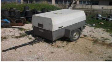
Kompresori " Bottarini" MSC43 me motor Lombardini LDW 1204
