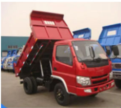
Figura 3: Makina vetëshkarkuese që mund të përdoren për lëvizjen e dherave dhe rotullat e membranave.
