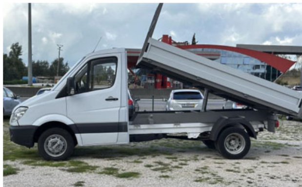
Figura 3: Makina vetëshkarkuese që mund të përdoren për lëvizjen e dherave dhe rotullat e membranave.
