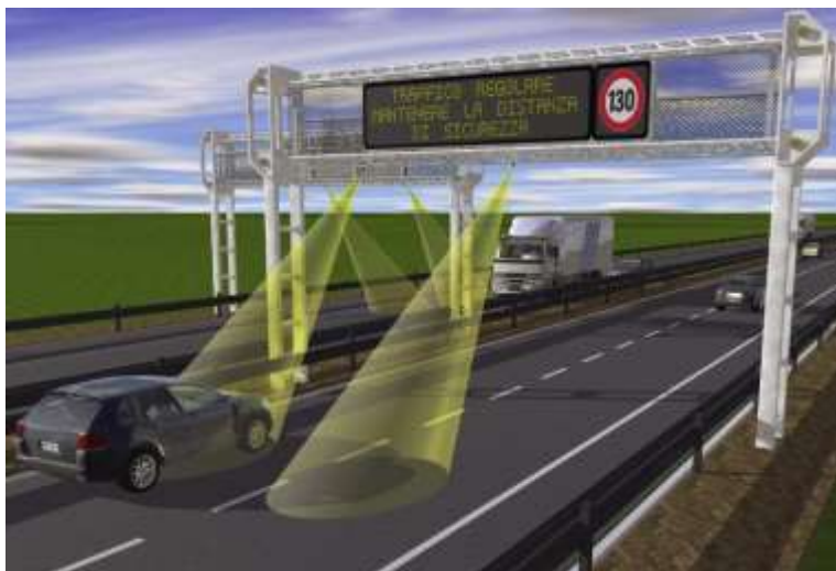
Figura 76: Pamje e zonave të zbulimit të sensorëve për çdo korsi
