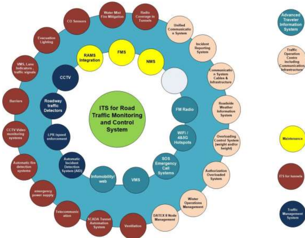
Figura 9: Sistemet e konsideruara në zhvillimin e RTMCS
