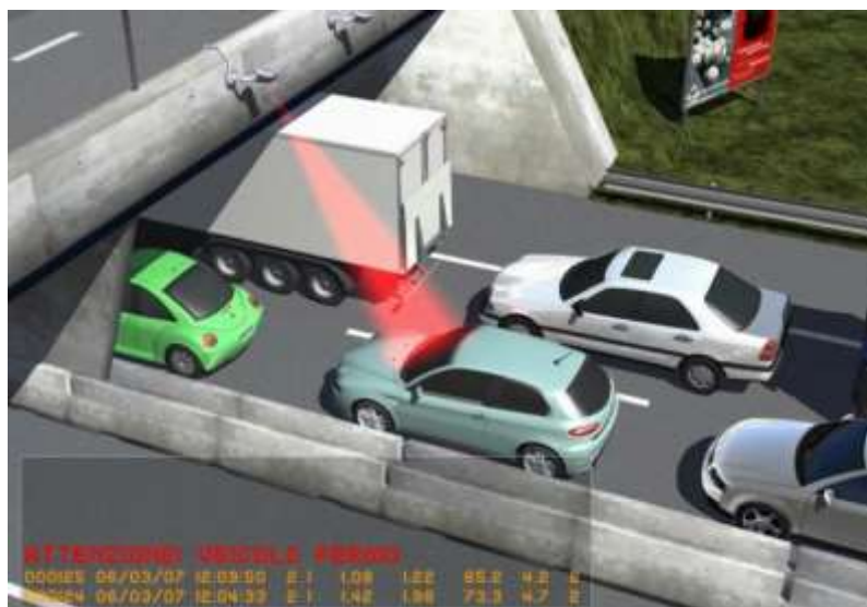
Figura 77: Piketimi i një automjeti të palëvizshëm në zonën e zbulimit
