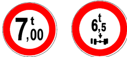
Figura 28 Ndalimqarkullimi i mjeteve që kalojnë një masë/aks më të madhe se ....ton
