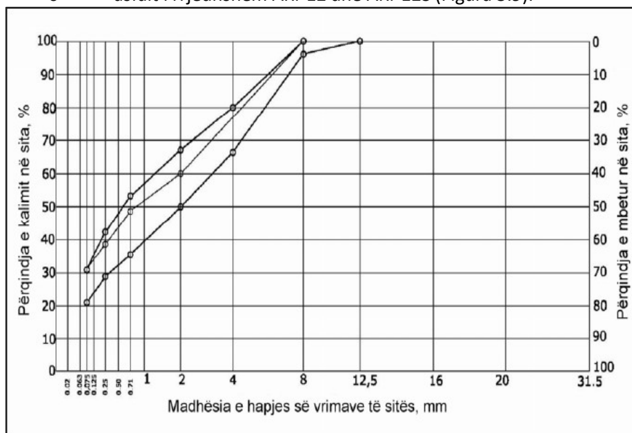
Figura 3.8: Kufinj të kompozimit të përzierjeve të kokrrizave të gurit për ShSLS prej asfalti të rrjedhshëm ARr 8 dhe ARr 8S
