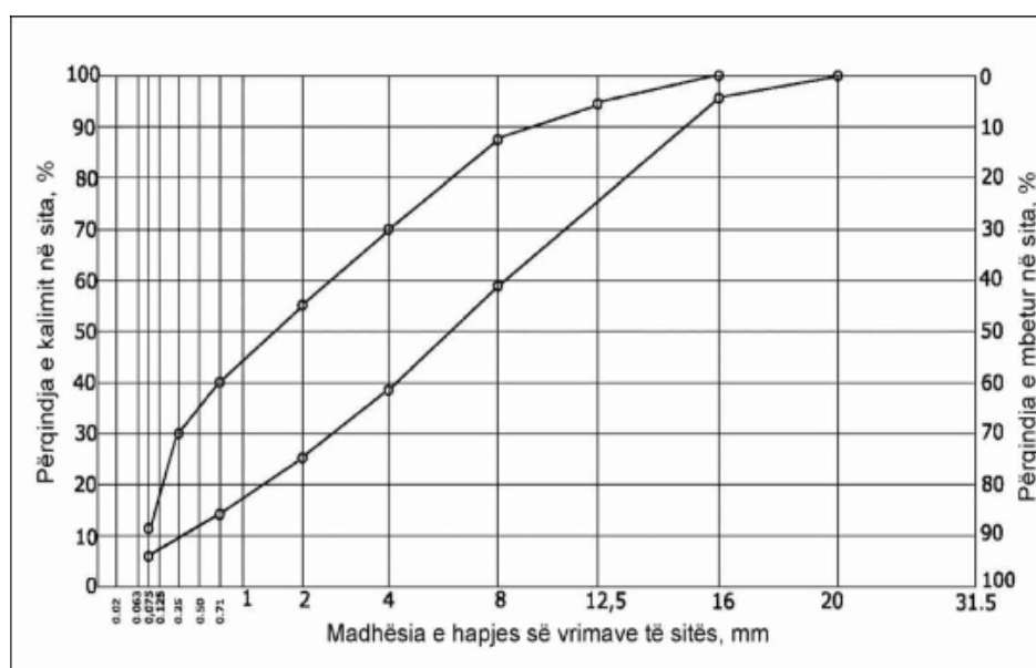
Figura 2.13: Kufinj të formimit të përzierjeve prej materiali të granular të kokrrizave të gurit për bazën prej makadami bituminoz - MB 22
