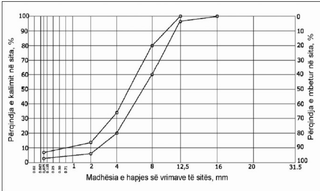
Figura 3.11: Kufinjët e kompozimit të përzierjes së kokrizave të gurit për ShSS prej përzierjeve të asfaltit poroz AP 12 dhe AP 12S
